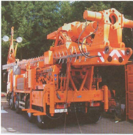
Abb. 1 Mit dieser Anlage wurde eine verrohrte Großlochhammerbohrung in Luxemburg mit einer Gesamtleistung von 10 bis 15 Meter pro Schicht durchgeführt.
