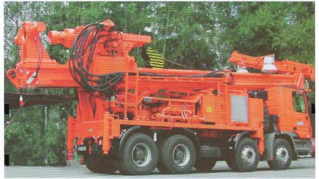
Abb. 5 Das Bohrgerät UH 4 ist mit 12,30 m Länge und 2,55 m Breite für 80 km/h zugelassen.
