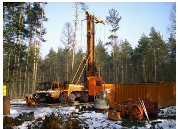
E+M Bohrgerät für Großbohrlochhammer
