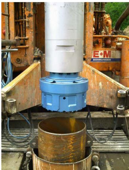
Hammer mit Bit bei Einfahrt in Hilfsverrohrung
