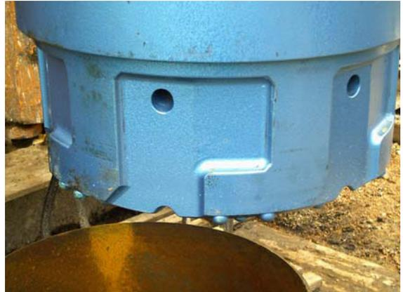
Verriegelungsmechanismus mit Bohrungen für Spülluft
